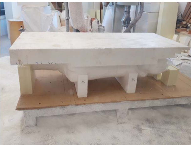
Figura 12. Posizionamento del Corpo sul piano di lavoro del Kuka [Lavorazione fronte]
